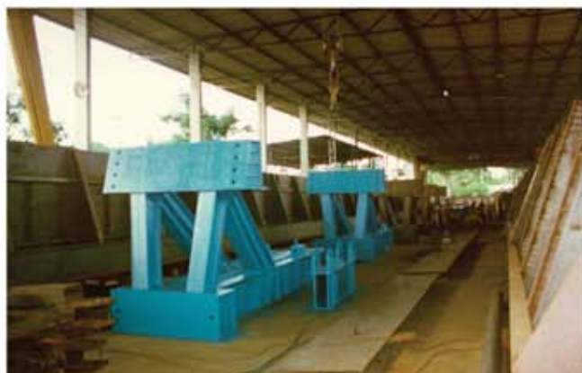
Fabricação de "Pier brackets" e Vigas de Apoio no pátio da FERRAL
