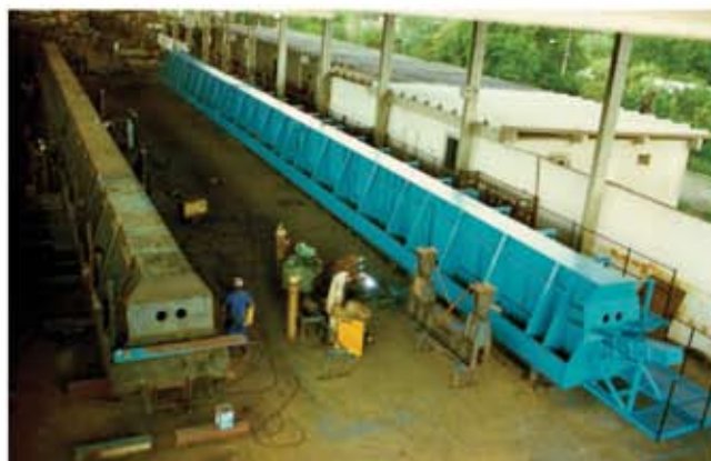
Fabricação de "Pier brackets" e Vigas de Apoio no pátio da FERRAL
