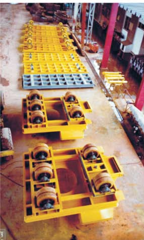
Lay out de carretas na etapa de acabamento no pátio da FERRAL
