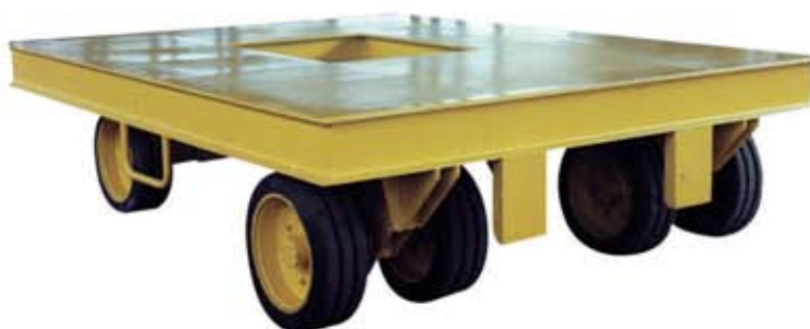
Carreta tipo Quinta roda para transporte de alumina com capacidade de 15 toneladas, suspensão biaxial e freios eletromagnéticos. Cliente: VALESUL ALUMÍNIO
