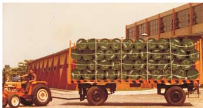
Carreta tipo Quinta roda para transporte de tambores, suspensão de feixe de mola capacidade 10 toneladas Cliente: PETROBRAS DISTRIBUIDORA
